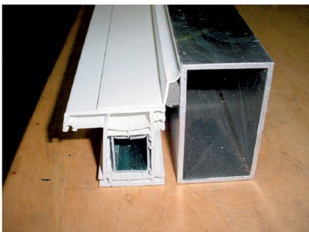
Bild 4: Probekörper 1000 mm lang (Probekörper 100 mm lang mit analogem Aufbau)
