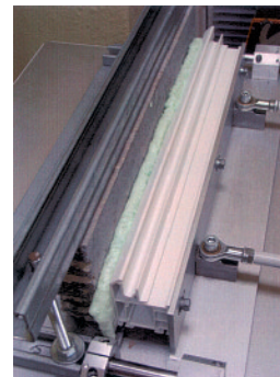
Bild 4: Beispiel einer Prüfeinrichtung mit ausgeschäumter Fuge
