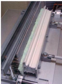
Bild 4: Beispiel einer Prüfeinrichtung mit ausgeschäumter Fuge
